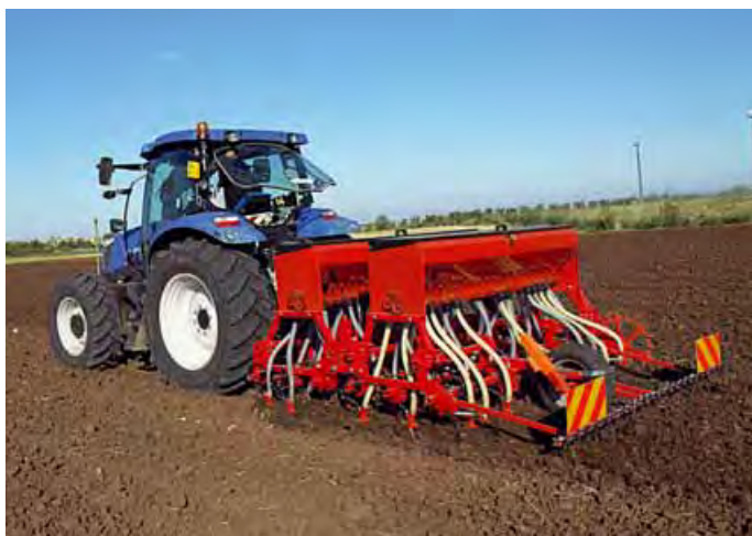
Foto 3 Prototipo della seminatrice in grado di distribuire il seme in file distanti pochi centimetri ( \leq 5 cm) simulando una semina a spaglio e assicurando una corretta profondità di semina
